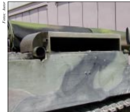
Die deutsche Abgashutze für die M-109 hat ausgezeichnete Wärmedämmwerte.
