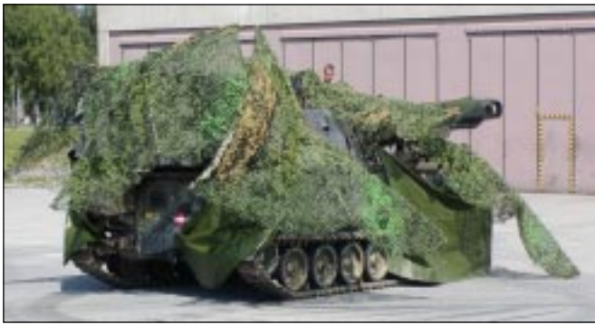
M-109A5Ö mit Schweizer Tarnnetz 95 auf „Wummel“ sowie mit Rohrtarnung und deutschem „Glattnetz“ mit Stützkonstruktion. (Fotos: Autor)
