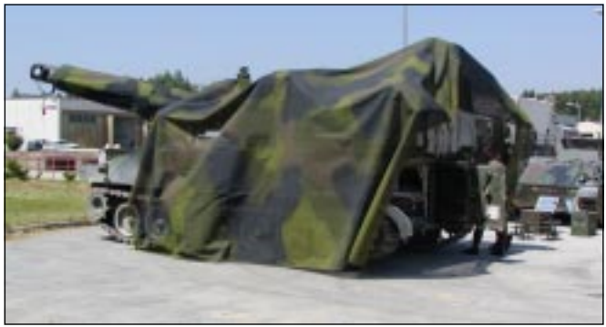
M-109A5Ö mit Schweizer Tarnnetz 95 auf „Wummel“ sowie mit Rohrtarnung und deutschem „Glattnetz“ mit Stützkonstruktion. (Fotos: Autor)
